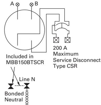
**Wiring Diagram Key**
