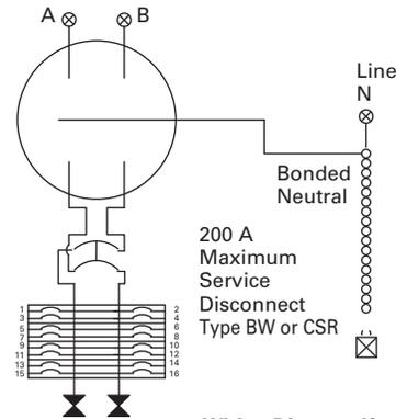
**Wiring Diagram Key**
