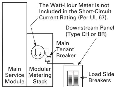
**1MM, 3MM, 200 A Meter Modules; 35MM, 37MM, 35SS and 37SS 225 A Meter Modules**
