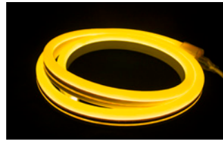
Amber LEDs Opaque Yellow Jacket (120V) 590nm • 21Lm/ft (24V) 590nm • 34Lm/ft P2-NF-AY (120V) P2-NF-24V-AY (24V)
