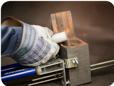
Step 4: Remove Clear cap from NUWTube, pour weld metal into mold.
