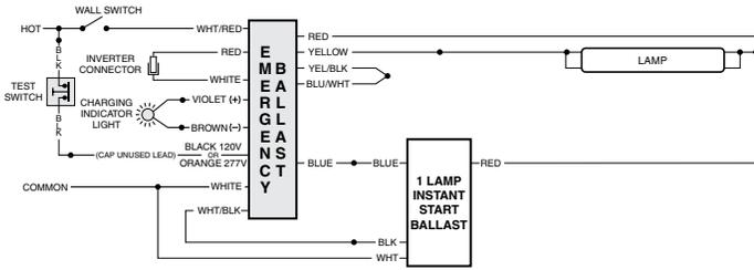
FIG B ONE (1) LAMP RAPID START BALLAST
