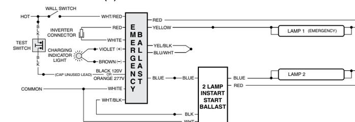
**EMERGENCY BALLAST AND AC BALLAST MUST BE FED FROM THE SAME BRANCH CIRCUIT**
